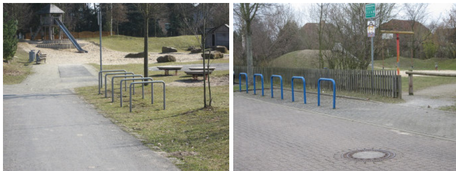
Abb. 82: Spielplätze mit Rahmenhaltern – Perspektivische Empfehlung ist der Einsatz von Doppelholmmodellen, um jeder Fahrradgröße ein standsicheres Abstellen zu ermöglichen
