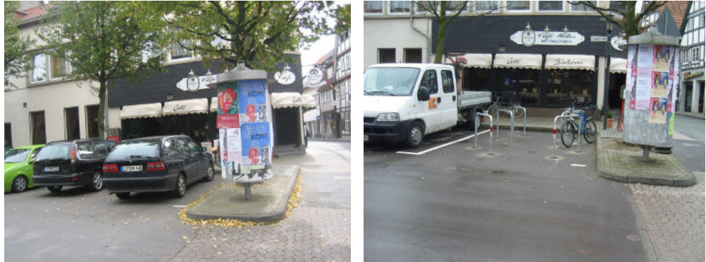
Abb. 69: Auf einem Kfz-Parkplatz können nach dem Umbau 12 Fahrräder stand- und diebstahlsicher abgestellt werden (Beispiel Lemgo)
