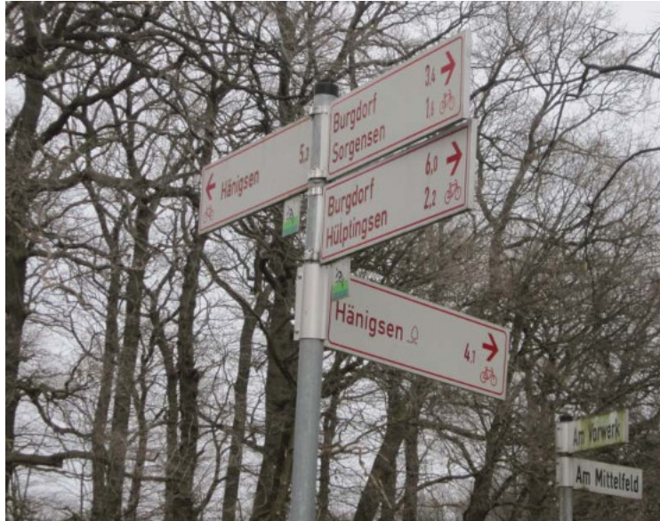
Abb. 55: Entfernungangaben sind zu prüfen und ggf. anzupassen. Werden gleiche Ziele über unterschiedliche Achsen gewiesen und weisen somit unterschiedliche Distanzen auf, so beginnt die differenzierende Ausweisung erst am Verzweigungsstandort. (Beispiel aus Dachtmissen)
