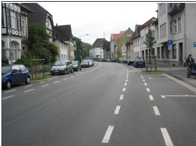
Abb. 31: Schutzstreifen mit Sicherheitstrennstreifen zu parkenden Kfz (Lemgo).
