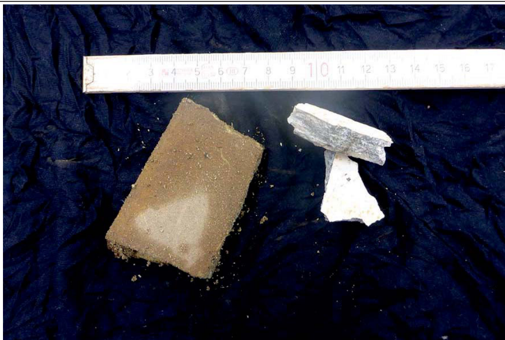
Abb. 4: Teilprobe aus Schurf-Nr. 10: Bruchstücke von Faserverbundplatten - mit Asbestverdacht (12.02.2016).
