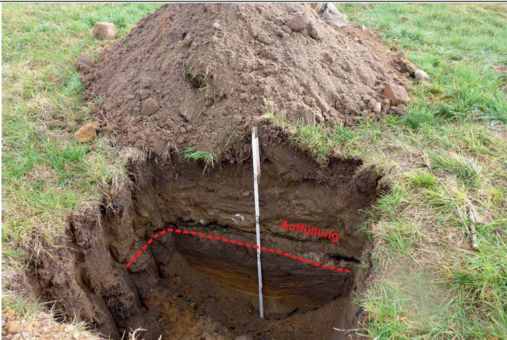
Abb. 2: Schurf-Nr. 5: Baggerschurf bis ca. 1,0 m u. Gok. - Auffüllung mit bodenfremden Bestandteilen (ca. 5 Vol.-% Ziegel, Beton, PE-Folie, Kalksandstein, Kohle, Altholz) über ehem. Ah-Horizont. (12.02.2016).
