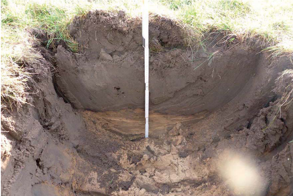
Abb.1: Schurf-Nr. 1: Baggerschurf bis ca. 0,7 m u. Gok. - Humoser Oberboden über Bv-Horizont - ohne bodenfremde Bestandteile (12.02.2016).
